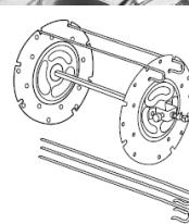
Halten Sie zum Entnehmen nach Beendigung des Garvorgangs den Entriegelungsknopf (15) rechts und heben Sie das Zubehör mit dem Griff (12) an und ziehen Sie es heraus.
