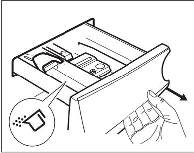
4. Per utilizzare il detersivo liquido, ruotare l'inserto verso il basso.
