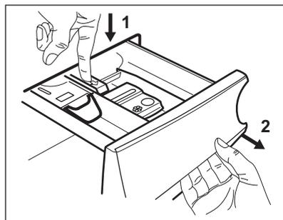
3. Per utilizzare il detersivo in polvere, ruotare l'inserto verso l'alto.
