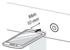
**3** Tenere premuto il pulsante **Aumenta Durata** per 3 o più secondi mentre si tiene il microfono dello smartphone sul tasto **Accensione** fino al completamento del trasferimento dati.
