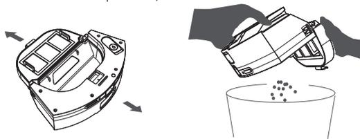
③ Rimuovere il filtro preliminare, la spugna e il filtro HEPA, pulire la superficie con una spazzola per la pulizia, sciacquare il filtro e il contenitore della polvere con acqua e lasciare asciugare;
