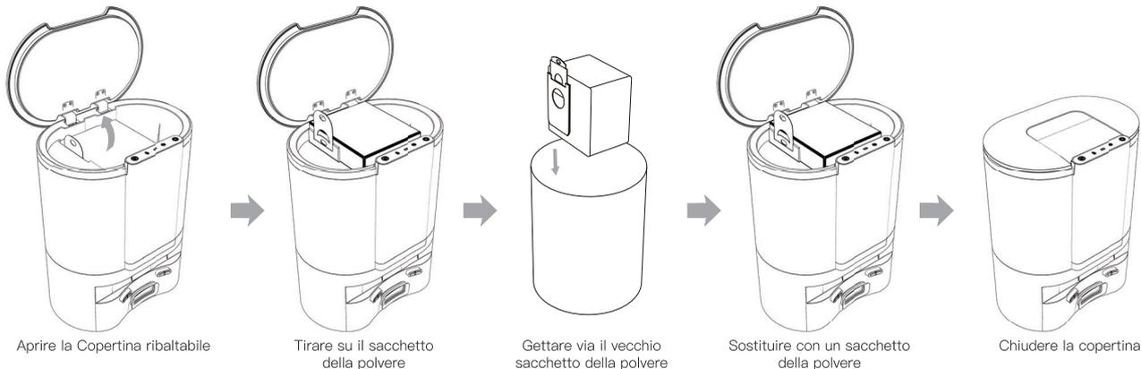
\*Nota: il dispositivo di fissaggio sigilla la polvere e i detriti nel sacchetto della polvere.
