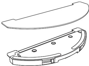
② Installare il serbatoio dell'acqua nell'unità principale del robot secondo la direzione indicata nel diagramma e assicurarsi che la clip sia in posizione;
