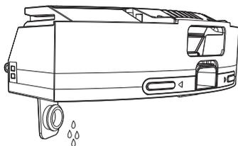
⑥ Dopo che il filtro, il contenitore della polvere, il panno ed il serbatoio dell'acqua si sono asciugati, rimetterli insieme per l'uso.
