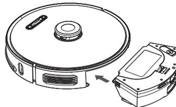
④ Premere con le mani le clip su entrambi i lati del portapanni e spingerlo nella parte inferiore dell'unità principale del robot orizzontalmente nella direzione indicata.
