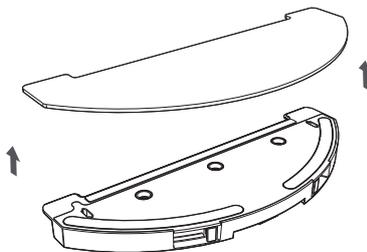
⑤ Versare l'acqua rimanente dal serbatoio dell'acqua e asciugare il serbatoio;
