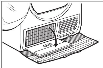
5. Se necessario, togliere la lanugine dal condensatore e dal suo alloggiamento. Con la spazzola si può utilizzare un panno inumidito e/o un aspirapolvere.
