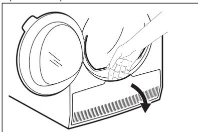
3. Ruotare la leva per sbloccare il coperchio condensatore.
