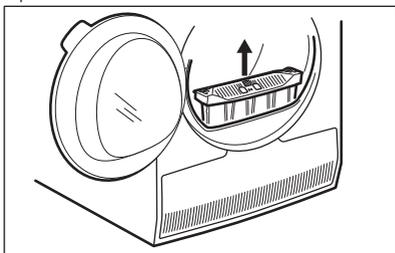
2. Aprire la copertura del condensatore.
