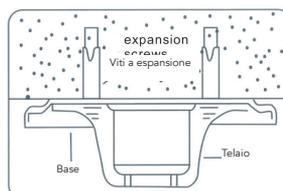
Usare una punta  $\varnothing$  8 mm per realizzare i fori e viti a espansione M6 per l'installazione.
