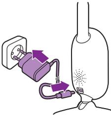
Coloque o adaptador de corrente na unidade do bebé e ligue o adaptador à tomada elétrica.
