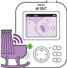
Wanneer door de babyunit geluid wordt opgevangen, worden het display en het geluid van de ouderunit onmiddellijk ingeschakeld. De geluiden worden aan de ouderunit doorgegeven.
