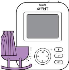
Wanneer de VOX-modus is geactiveerd, worden het display en het geluid van de ouderunit uitgeschakeld als er gedurende 20 seconden geen geluid wordt gedetecteerd.
