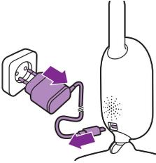
**1** Desligue a unidade do bebé, retire o adaptador de corrente desta unidade e retire-o da tomada elétrica.
