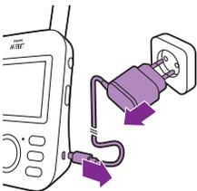
**3** Schakel de ouderunit uit, haal de stekker uit de ouderunit en haal de netspanningsadapter uit het stopcontact.
