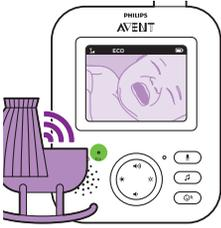
Wanneer door de babyunit geluid wordt opgevangen, worden het display en het geluid van de ouderunit onmiddellijk ingeschakeld. De geluiden worden aan de ouderunit doorgegeven.
