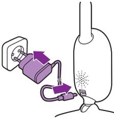
Koble strømadapteren til babyenheten, og koble adapteren til veggkontakten.
