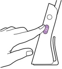
När babyenheten är på kan du växla mellan dessa fyra olika lägen genom att trycka på den lägesknapp som finns på sidan av föräldraenheten.
