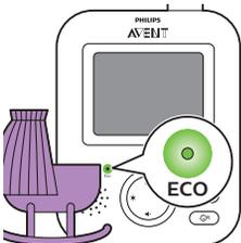
Quando la modalità ECO è attivata, il display e l'audio dell'unità genitore si disattivano se non viene rilevato alcun suono entro 20 secondi. La spia ECO emette un colore verde per indicare che la modalità ECO è attivata. Durante la modalità ECO le trasmissioni del display e dell'audio sono disattivate.
