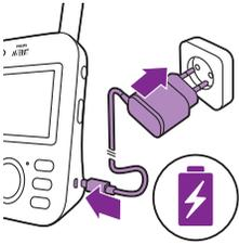
1 Steek de kleine stekker in de ouderunit en steek de netspanningsadapter in het stopcontact.
