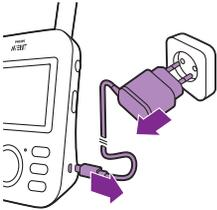
**3** Desligue a unidade dos pais e retire o adaptador da tomada elétrica.
