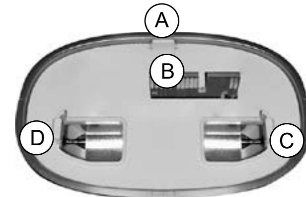
Prestar atención a la dirección de inserción de la lámpara. Detrás de la lámpara hay 3 patillas de plástico (A, C, D) y una placa electrónica (B). Durante la instalación de la lámpara, hay que tener cuidado para que coincidan éstos elementos con sus alojamientos en la máquina de ataque. La instalación y el retiro de la lámpara no necesitan ningún equipo y se hace a mano con la máquina apagada y desconectada de la toma de corriente eléctrica.
