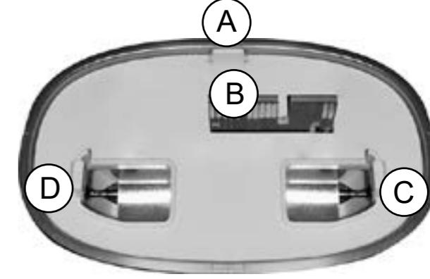
Achten Sie auf die Einführungsrichtung. Hinter dem Licht sind 3 Kunststoff-Gelenkscharniere (A C D) und eine elektronische Karte (B) zu finden. Bei der Montage ist darauf zu achten, dass diese Elemente mit den entsprechenden Gehäusen am Gerät befestigt werden. Die Montage und Demontage des Lichts erfordert keine Ausrüstung und kann von Hand erfolgen, wenn das Gerät ausgeschaltet und von der Steckdose getrennt ist.
