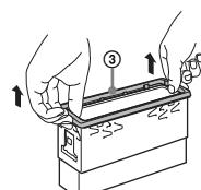
**2** Вставьте оба ключа для демонтажа ② до щелка, потяните кронштейн ① вниз, а затем потяните устройство вверх, чтобы отсоединить его.
