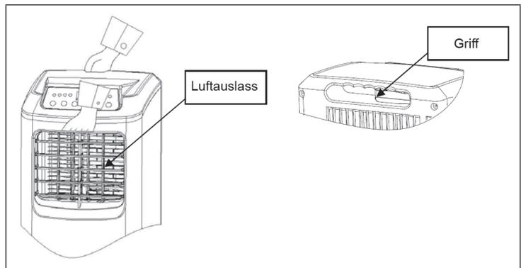
**Hinweis:** Halten Sie das Gerät nicht an einem der horizontalen Lüftungsschlitze und kippen Sie es beim Transport nicht. Falls sich die Fernbedienung im Einschub befindet, entfernen Sie sie, bevor Sie das Gerät anheben.
