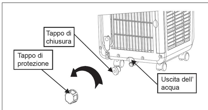
**Nota:** Prestare attenzione a non smarrire il tappo di chiusura e il tappo di protezione. Nel caso in cui il contenitore di raccolta sia pieno, prima di svuotare del tutto il serbatoio, inserire prontamente il tappo di chiusura nella valvola affinché l'acqua non finisca sul pavimento.
