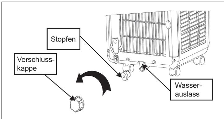
**Hinweis:** Achten Sie darauf, dass Sie den Stopfen und die Verschlusskappe nicht verlieren. Falls das Auffanggefäß voll ist, bevor sie den Tank komplett entleert haben, schieben Sie rechtzeitig den Stopfen ins Ventil, damit das Wasser nicht überläuft und Ihren Boden flutet.
