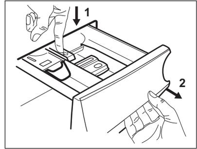
3. Per utilizzare il detersivo in polvere, ruotare l'inserto verso l'alto.
