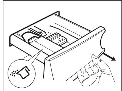
4. Per utilizzare il detersivo liquido, ruotare l'inserto verso il basso.
