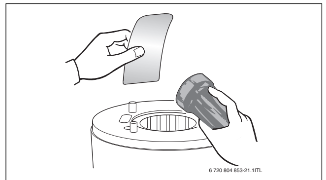
Fig. 53 Controllo della presenza di residui nello scambiatore primario
