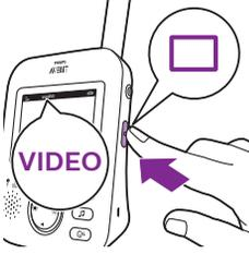
VIDEO modunu seçmek için ebeveyn ünitesinin kenarındaki mod düğmesine basın.
