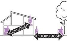
Senderækkevidden er 50 meter indendørs og 300 meter udendørs. Babyalarmens rækkevidde afhænger af omgivelserne og andre faktorer, der kan forårsage interferens. Våde og fugtige materialer kan give op til 100 % tab i rækkevidden på grund af interferens.
