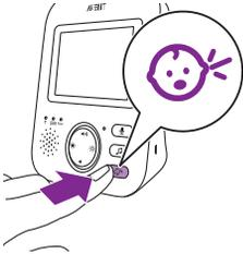
**2** Pulse la parte superior o inferior del botón de control para seleccionar el nivel de sensibilidad deseado.
