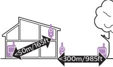
El alcance de funcionamiento es de hasta 50 metros en interiores y de hasta 300 metros en exteriores. El alcance de funcionamiento del vigilabebés varía en función del entorno y de los factores que provocan interferencias. Los materiales mojados y húmedos provocan tantas interferencias que la pérdida de alcance puede ser de hasta el 100 %.
