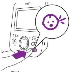
**2** Per selezionare il livello di sensibilità desiderato, premete la parte superiore o inferiore del pulsante di controllo.
