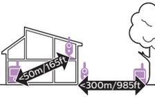
Der Betriebsbereich beträgt bis zu 50 Meter im Innenbereich und 300 Meter im Außenbereich. Die Reichweite des Babyphones ist von der Umgebung und von eventuellen Störfaktoren abhängig. Nasse und feuchte Materialien können die Reichweite um bis zu 100 % verringern.
