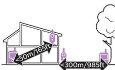
Räckvidden är upp till 50 meter inomhus och upp till 300 meter utomhus. Babyvaktens räckvidd varierar beroende på omgivningen och andra faktorer som ger störningar. Våta och fuktiga material kan orsaka så mycket störningar att räckvidden försämras med upp till 100 %.
