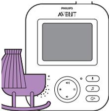
O visor da unidade dos pais desliga-se, mas o modo AUDIO (Áudio) é ativado. Três segundos após a seleção do modo AUDIO (Áudio), o visor desliga-se.
