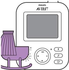
O visor e o som da unidade dos pais irão desligar-se se não for detetado som durante 20 segundos, mas o modo VOX (Voz) é ativado.
