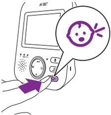
**2** Appuyez sur la partie inférieure ou supérieure du bouton de commande pour sélectionner le niveau de sensibilité souhaité.
