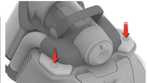
6. **Porniți/opriți aspiratorul** apăsând butonul PORNIRE/OPRIRE. După aspirare **înfășurați cablul de alimentare apăsând butonul REWIND (ÎNFĂȘURARE).**
