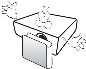
7. Durante il funzionamento dell'apparecchio, la lampada raggiunge temperature elevate. Lasciare raffreddare il proiettore per circa 45 minuti prima di rimuovere il complesso lampada per la sostituzione.
