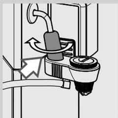
**28** Verificare che sia correttamente posizionato. Se non si riesce ad inserire si deve ruotare la copertura cromata. Il Montalatte Automatico è montato correttamente quando il dente s'inserisce nella scanalatura.
