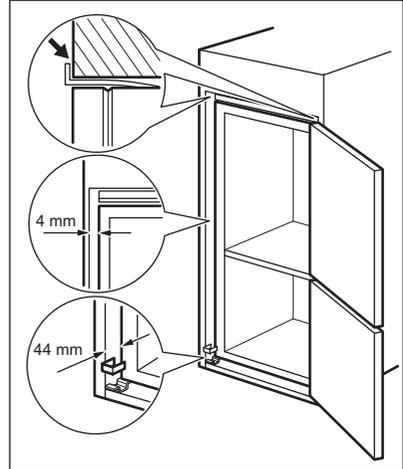
7. Fissare l'apparecchiatura nella nicchia con 4 viti.
