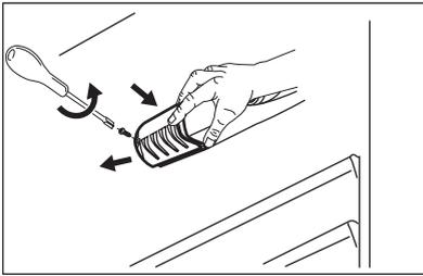
3. Sostituire la lampadina con una nuova della stessa potenza (la potenza massima è indicata sul coprilampada) concepita in modo specifico per elettrodomestici.
