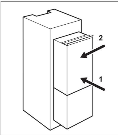
4. Spingere l'apparecchiatura nel senso delle frecce (2) contro il mobile sul lato opposto della cerniera.
