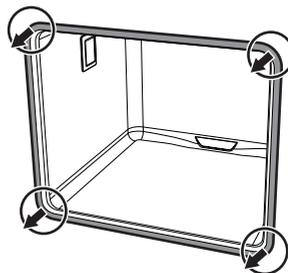
Per montare la guarnizione forno:
