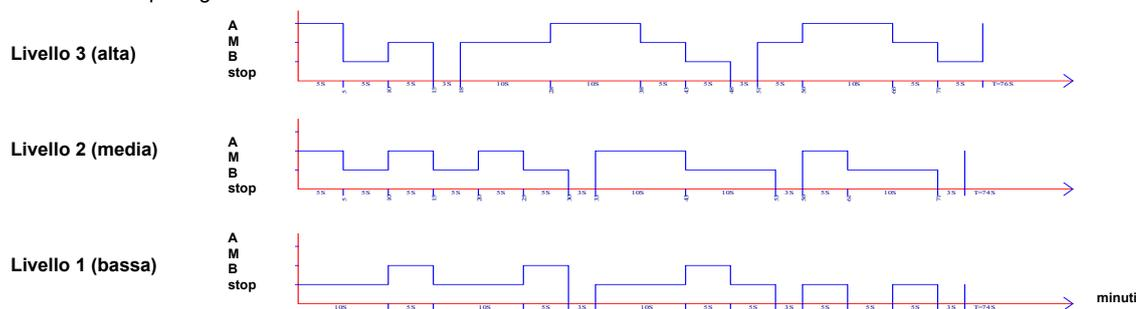
La modalità "Sleep" gestisce 3 livelli di ventilazione (1, 2, 3) prevedendo per ciascuno di essi una diversa alternanza di periodi di alto, medio e basso regime della modalità Natural, per una ventilazione più adatta alle ore notturne.
